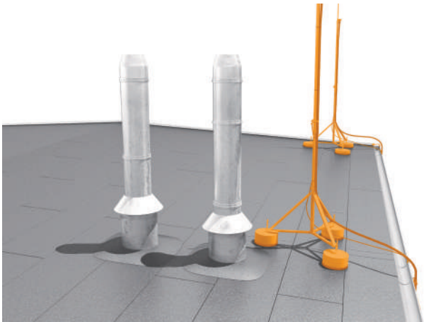
Рис. 2.70: Молниеприемные мачты isFang с расположенным снаружи проводом isCon®
