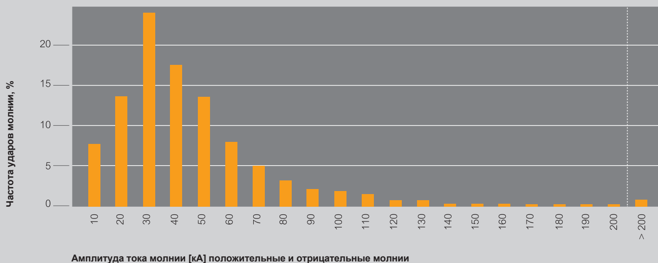
Рис. 1.2: Распределение частоты ударов молнии по амплитуде тока молнии
