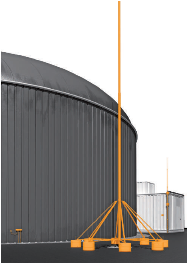
Рис. 2.30: Молниеприемные телемачты: применение для установки, работающей на биогазе
