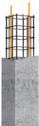
Рис. 2.53: Пример: Использование железобетонных опор в качестве молниеотводов
