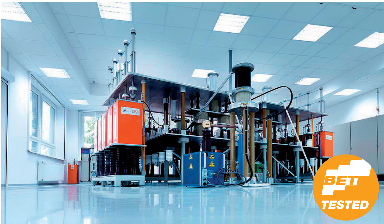
Рис. 2.97: Генератор тока молнии BET и знак качества BET
