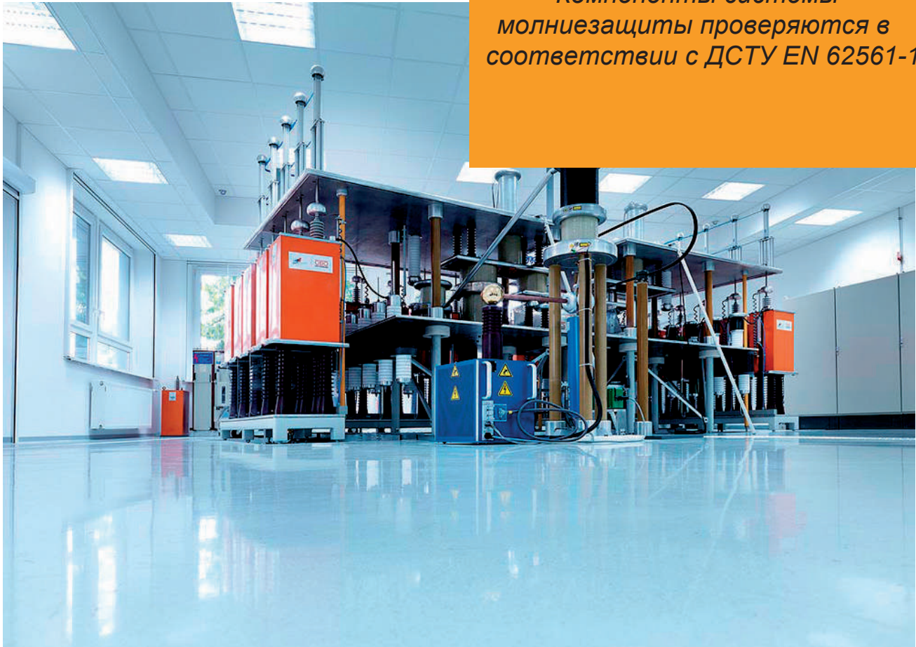
Рис. 4.2: Генератор тока молнии BET
