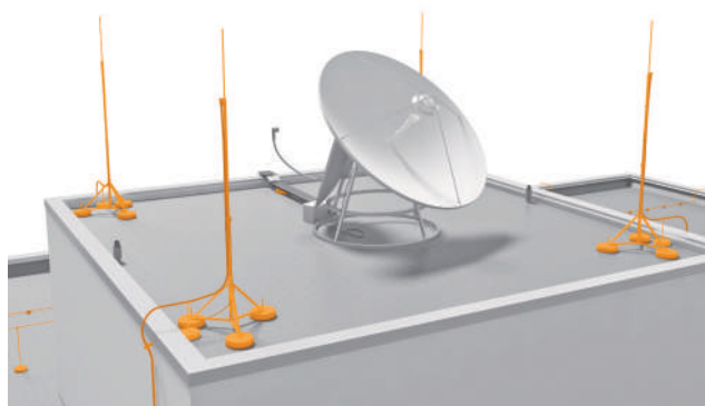
Рис. 2.61: Изолированная молниезащита с молниеприемными стержнями
