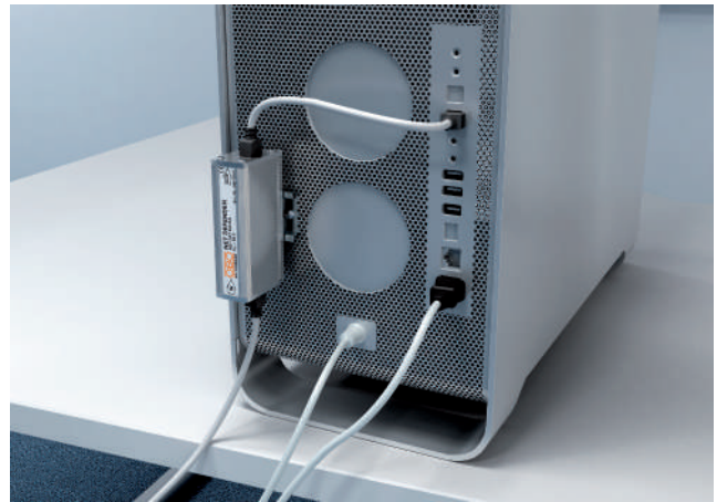
Рис. 3.82 Рекомендация по защите на оконечном устройстве.
