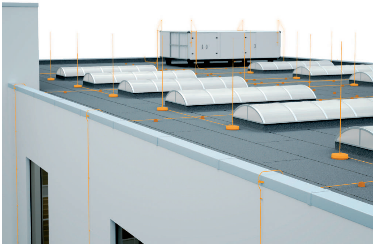
Рис. 2.14: Естественные компоненты (здесь: жестяной аттик) для молниеприемников (ДСТУ EN 62305-3:2012)
